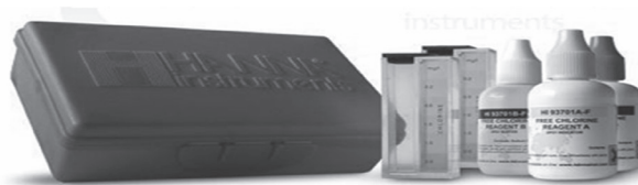
Figura 8. Esquema alusivo a un kit para determinar cloro residual
